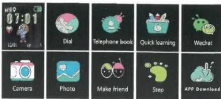
**Interface principale :** la petite icône sur la première ligne correspond au signal GSM, au mode d'appel, à la marque de réseau, à l'icône de positionnement, à la marque de voix (non marquée dans le diagramme), à la marque de batterie, en dessous se trouvent l'heure et la date.
